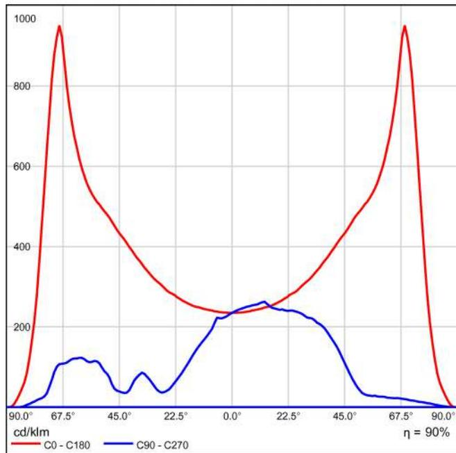
Non è possibile creare un diagramma conico, poiché la diffusione luminosa è asimmetrica.
