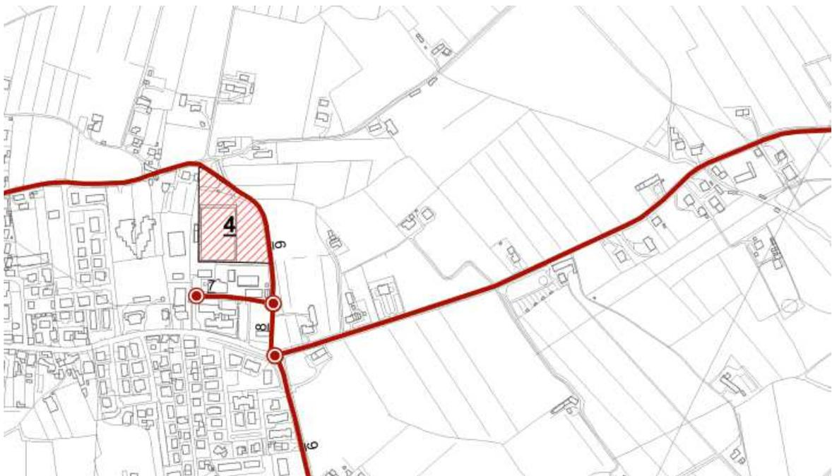
Figura 5: L'infrastruttura AC 0000000006, il tratto dell'infrastruttura AC 0000000011 e l'Area di Emergenza AE 0000000004 ricadenti in una zona soggetta a liquefazioni
